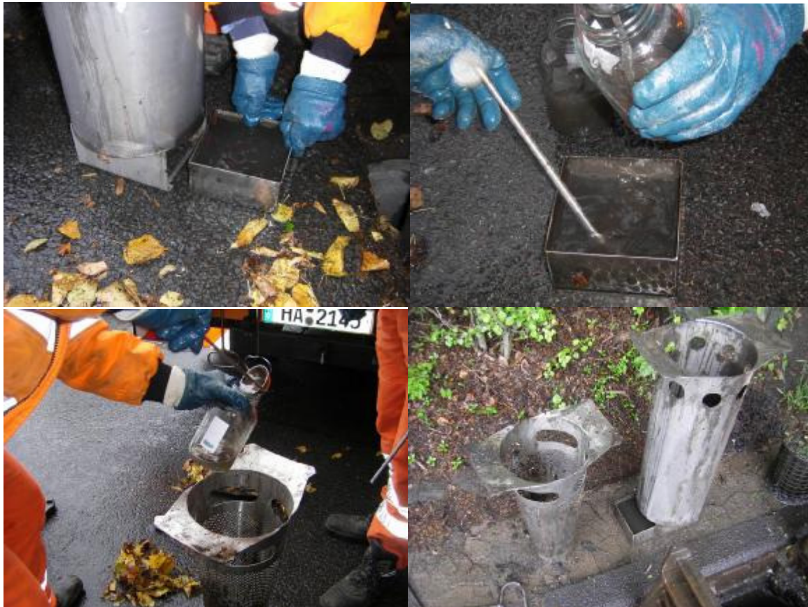
Abb. 8: Probenahme Ablauf (obere Bilder) und Zulauf
