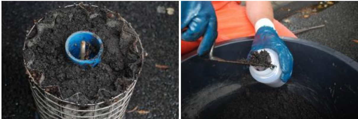
Abb. 13: Probenahme INNOLET Filtermaterialien
