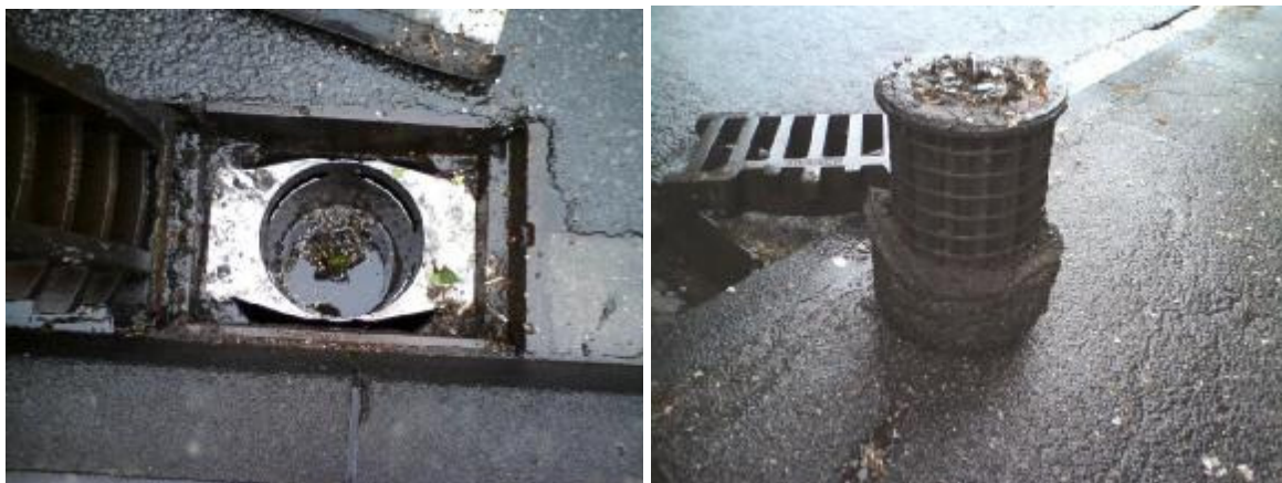
Abb. 27: Zusetzen der Filtermantelfläche durch feine Pollen im Frühjahr
